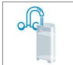
1. **Vacié** el depósito de agua, **enjuáguelo** y **llénelo** con agua potable.
