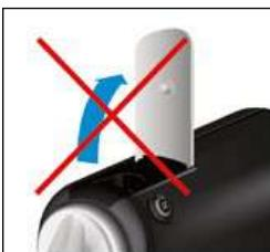
5. **No levante** la palanca durante el proceso de descalcificación.
