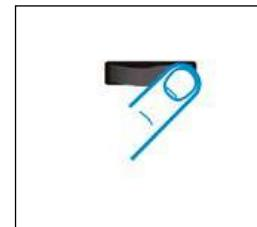
**6. Interruptor en posición OFF (El aparato se bloquea durante 10 min puede gotejar un poco de agua).
