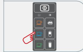
11. A máquina distribui a solução descalcificante 5 vezes em intervalos de 10 minutos com duração de aproximadamente 45 minutos. Durante a descalcificação, não aperte qualquer botão enquanto as luzes indicadoras Multifunções e Descalcificação piscam alternadamente em AMARELO e VERMELHO.
