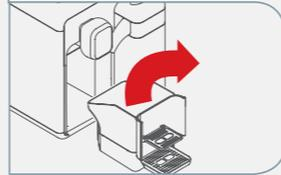
13. Deslize o distribuidor de bebidas para cima e desmonte as peças.
