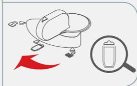
19. Deixe as peças do vaporizador submersas em um recipiente com detergente neutro por aproximadamente 30 minutos. Não submergir a máquina na água.
