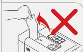
2. Se a alavanca for levantada durante o preparo de uma bebida, a luz indicadora multifunções pisca em VERMELHO, a distribuição é imediatamente interrompida e a máquina emitirá um sinal sonoro.
