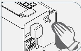
21. Encaixe o vaporizador na máquina novamente.
