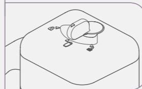
3. Levante a alavanca para abrir o porta-cápsulas.
