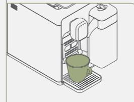
6. Pressione uma das teclas (laranja, azul ou verde) e aguarde a máquina terminar o ciclo de carga do circuito hidráulico. A luz indicadora multifunções se apagará.
