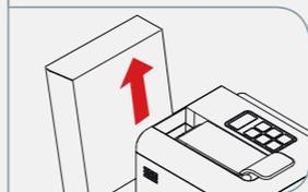
4. Misture o conteúdo de uma embalagem de descalcificante com cerca de 750mL de água (totalizando 1 litro) e coloque no reservatório.
