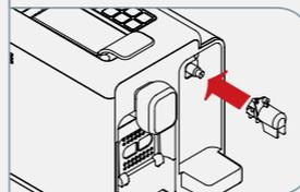
6. Coloque uma vasilha de pelo menos 500mL sob o distribuidor de café e o recipiente de leite (sem a tampa) embaixo do conector de descalcificação.
