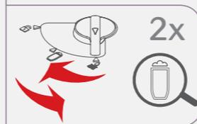
6. Ao final da segunda limpeza, volte o botão para a posição de vaporização.
