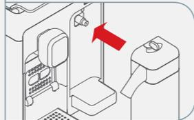
20. Enxágue o reservatório de água, encha-o com água fria e pressione uma das teclas laranja, azul ou verde e aguarde até que a luz indicadora de Multifunções se apague.
