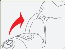
2. Se a alavanca for levantada durante a preparação de uma bebida, a luz indicadora multifunções pisca em VERMELHO e é emitido um sinal sonoro. A distribuição é imediatamente interrompida.
